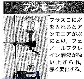
フラスコに水を入れるとアンモニアが水にとけ、フェノールフタレイン溶液が吸い上げられ、赤く変化する。
